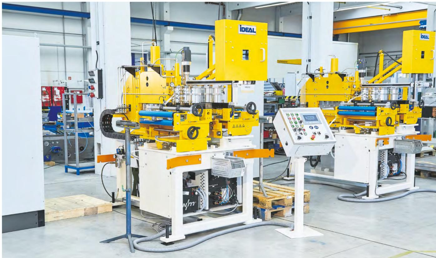
die einfache Handhabung. Im Vergleich zum Laserschweißen ist es einfacher zu bedienen und erfordert weniger komplexe Maschinen. Dadurch ist es auch wirtschaftlicher und bietet eine kostengünstige Lösung für das Bandschweißen von Elektro-Blechen.
