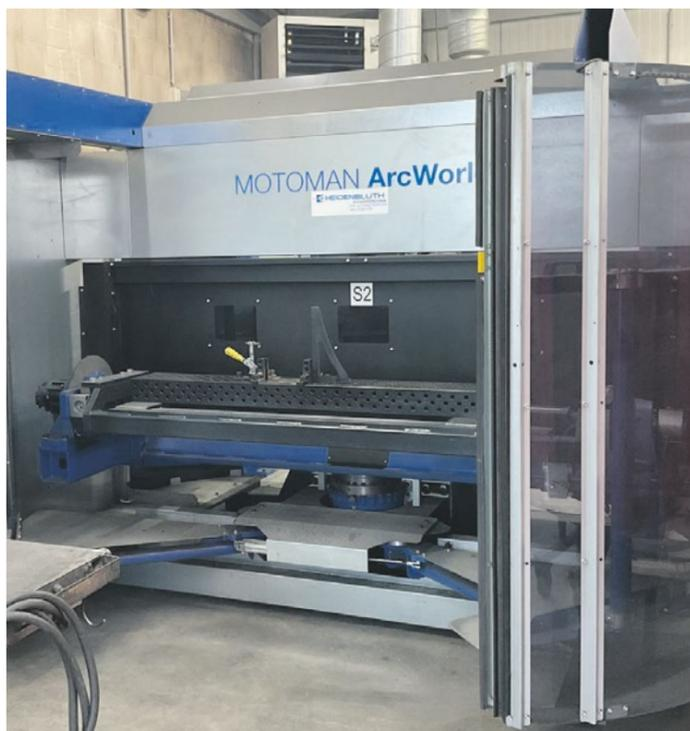
kann, hat sich gelohnt und ermöglicht eine noch effizientere und schnellere Arbeitsweise. Der Drehpositionierer erlaubt es auf der einen Seite verschiedenste Bauteile in allen Lagen extrem genau auf einer Aufspannung in MAG- und WIG-Schweißtechnik zu bearbeiten, während auf der anderen Seite neue Teile zum Schweißen vorbereitet werden können.
